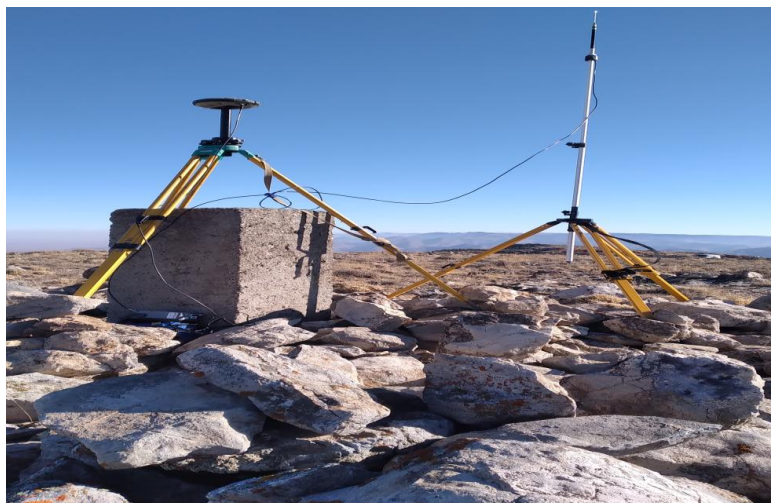
3 Сурет – Базалық станция
