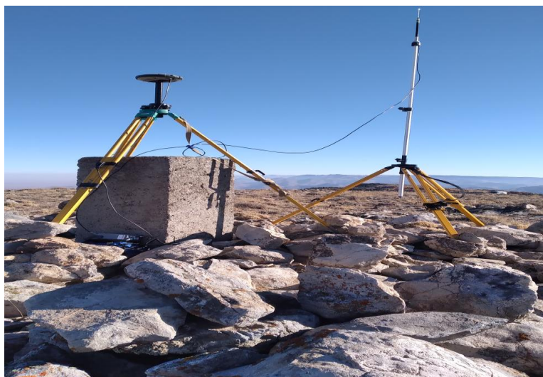
13 - сурет – Базалық станция
