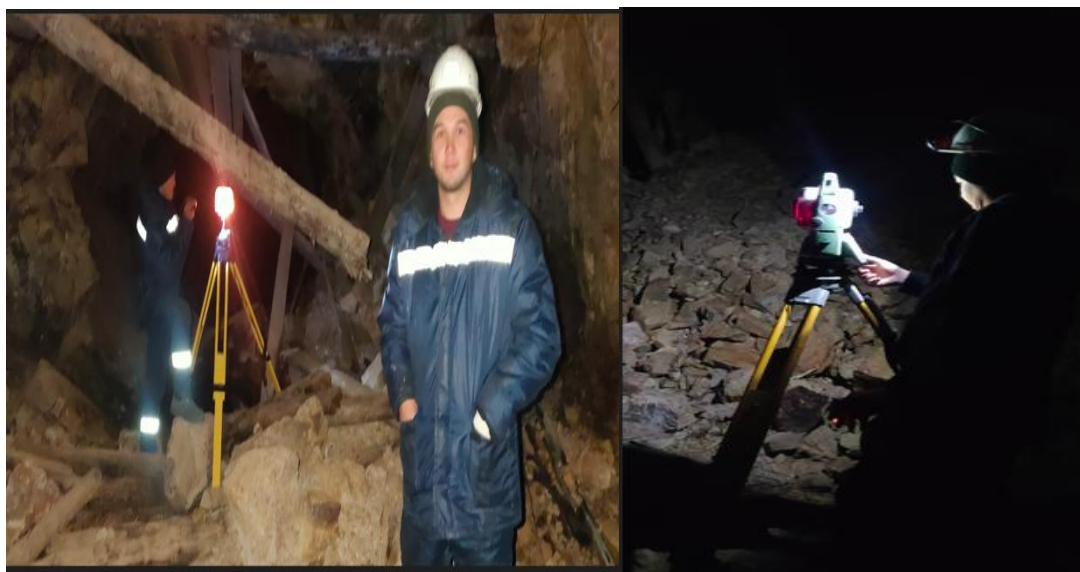
34 - сурет – Шахталарға координаттарды орналастыру
